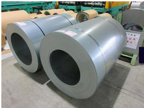
① 素材：コイル鋼材（薄板）
